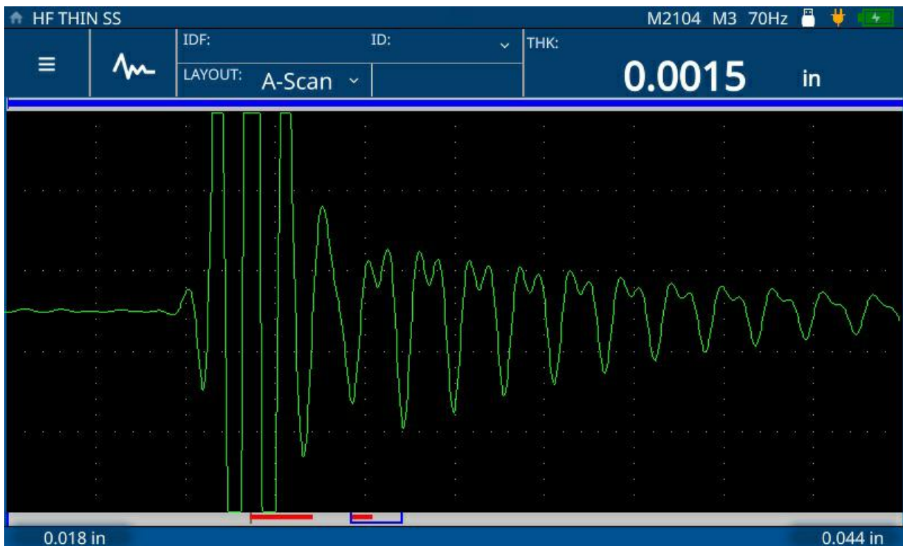
Il misuratore 72DL PLUS misura una sottile lamina in acciaio (0,0381 mm o 0,0015 in.) mediante il trasduttore M2104 (125 MHz)
